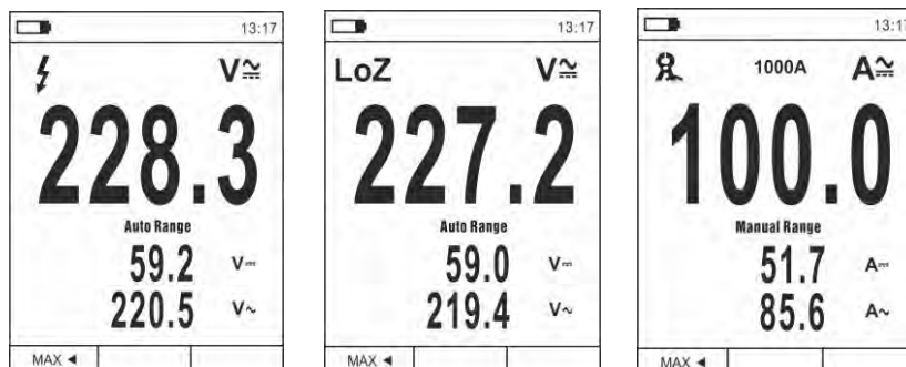
Fig. 6 Beschreibung der Messung von AC+DC Spannung und Strom
