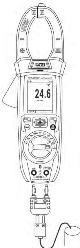
Fig. 30 Uso para medida de Temperatura Temperaturmessungen durchführen
