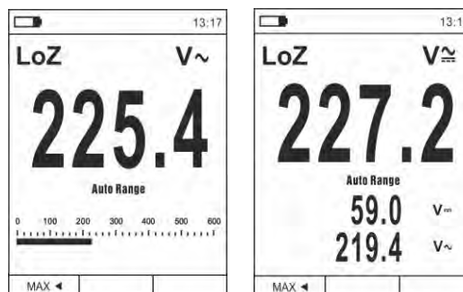
Fig. 10 Beschreibung der Messung von LoZ Spannung
