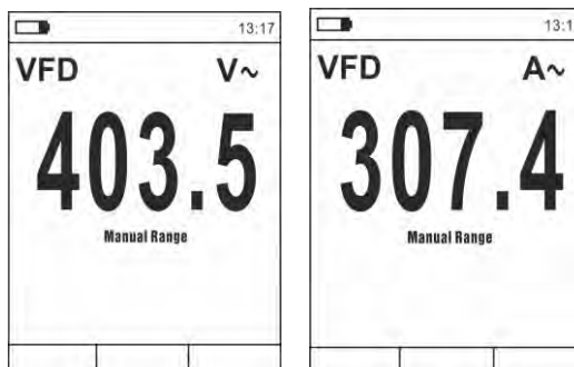
Fig. 11 Descripción medida de Tensión o Corriente CA en modo VFD
