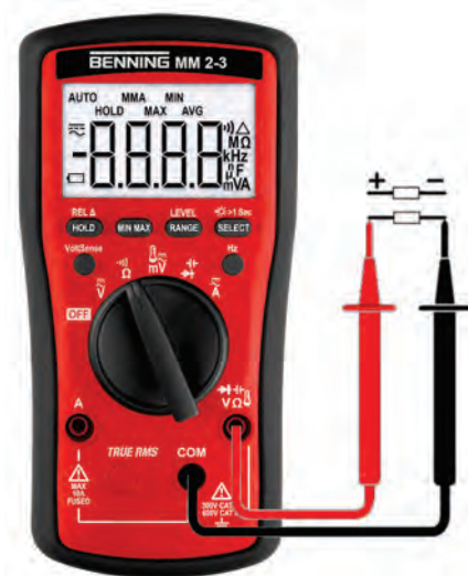
Abb. 11: Widerstandsmessung oder Durchgangsprüfung
