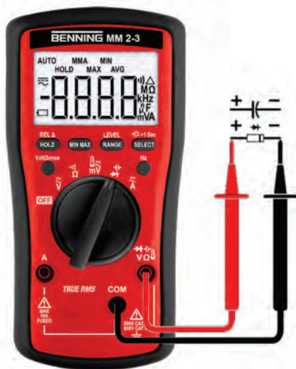
Abb. 12: Kapazitätsmessung oder Diodenprüfung
