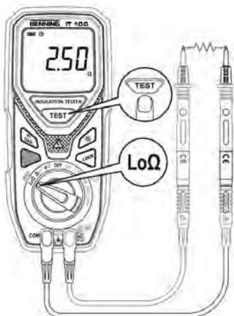
Abb.: Niederohmmessung Figure: Low-resistance measurement Illustration : Mesure de faibles résistances Afbeelding: Laagohmige meting
