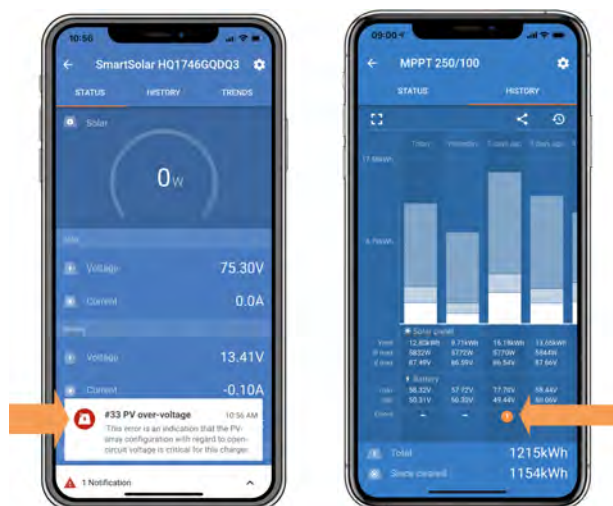
Ein aktiver Fehler und ein historischer Fehler.
