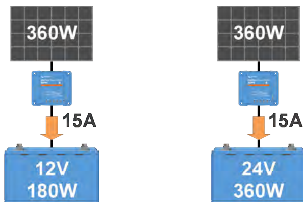
Beispiel für Unterschiede in der Ausgangsleistung bei verschiedenen Batteriespannungen
