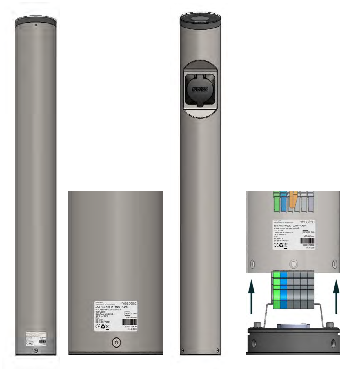
Position Typenschild: 1x Außen und 1x Kopie Innen im Gehäuse
